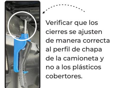
Verificar que los cierres se ajusten de manera correcta al perfil de chapa de la camioneta y no a los plásticos cobertores.
